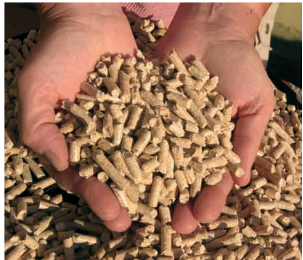
Holzpellet-Presslinge aus Sägemehl und Spänen
